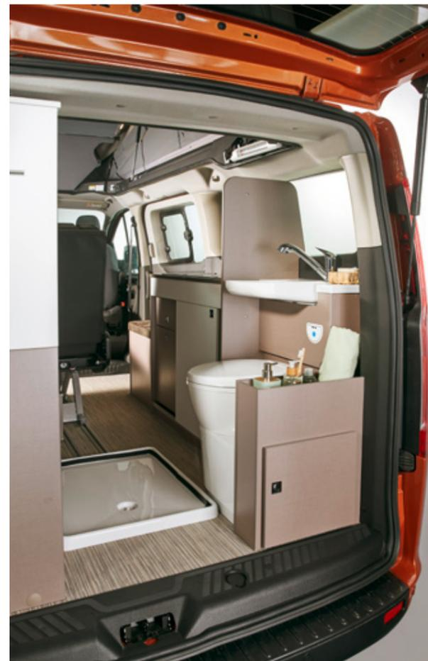
Ein Bad mit Klappwaschbecken, fest verbauter Kassetten-Toilette, einer steckbaren Duschwanne mit Duschvorhang sowie einem herausziehbaren Wasserhahn als Duschkopf.
