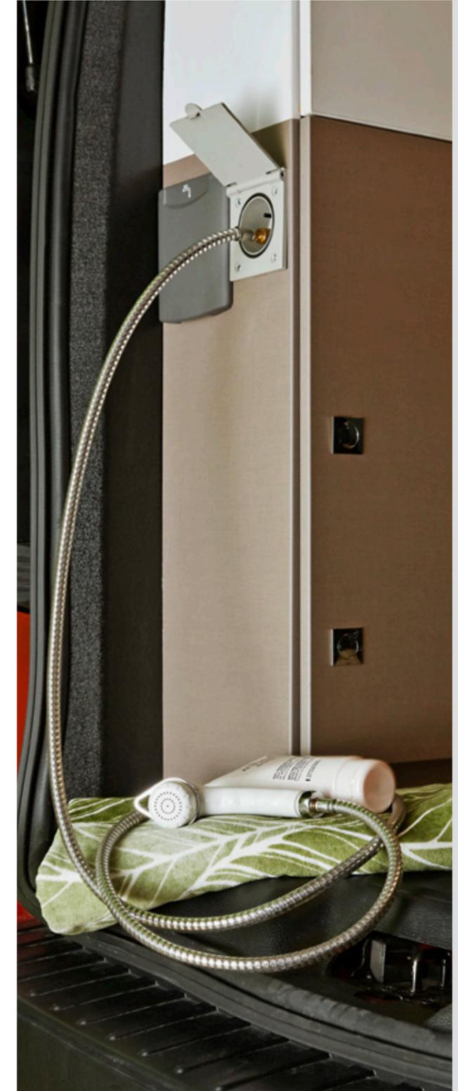
Anschluss für die Außendusche (Brausekopf mit Schlauch über Bürstner Zubehör „OTZ“ und als Option erhältlich).
